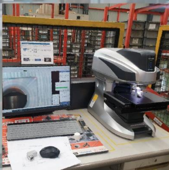
6. 3D SURFACE MEASUREMENTS IN AS LITTLE AS 4 SECONDS ใช้ในการสแกนวัด Profile ความเรียบผิว ได้: Dimensions
