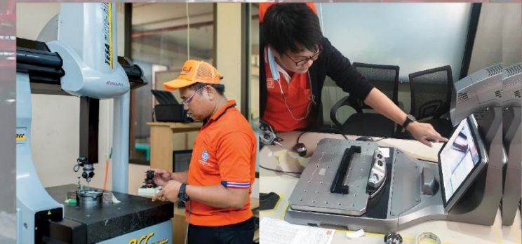
5. CMM 3D / วัดขนาดรูปแบบ 3D (high-precision coordinate measuring machine) ใช้ในการวัด Dimensions ตามแนวแกน X, Y, Z จากการใช้ปลายหัวโพรม
