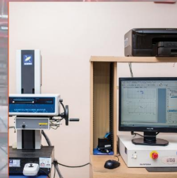
4. CONTOURED CORD 1600M ใช้ในการวัดองศา Radius Chamfer
