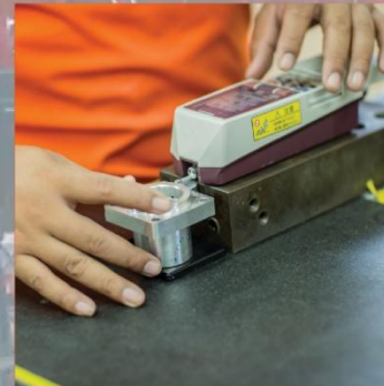
3. SURFACE ROUGHNESS TESTER ใช้ในการวัดความเรียบผิว ของชิ้นงานมีค่าเป็น Ra , Rq , Rz
